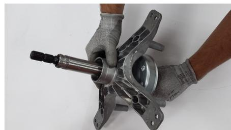
Passo 3: Encaixe o adaptador retentor no mecanismo
