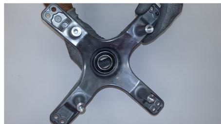
Passo 2: Encaixe o mecanismo no suporte do tanque
